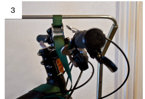
3 Den anderen Gurt unter den Vorbau bringen und die Höhe durch Anheben der Velofront regeln
