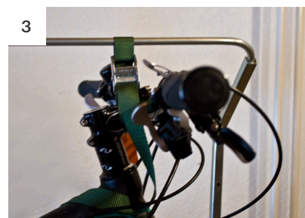
Passer l'autre sangle sous la potence et régler la hauteur en soulevant l'avant du vélo
