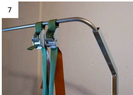
Placer l'arceau dans les 2 montants
